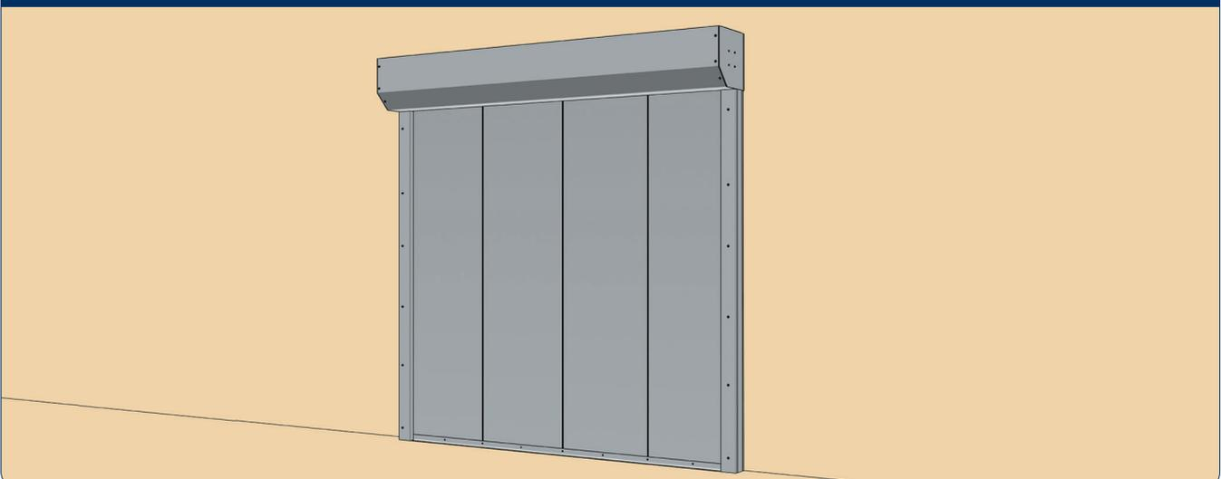
Проверьте правильность и надежность установки конструкции. Поднимите и опустите несколько раз полотно противодымной шторы. Убедитесь в отсутствии посторонних звуков и в надежности крепления всех элементов.
