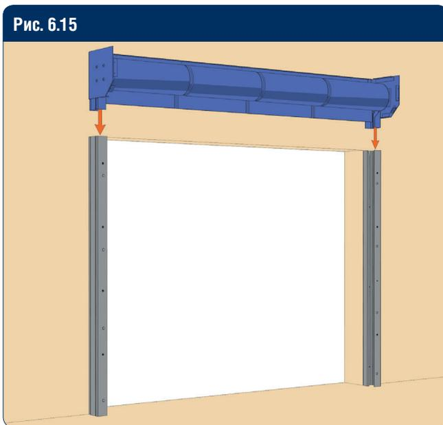
Установите корпус с противодымной шторой на направляющие.
