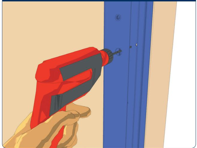
Просверлите отверстия в стене для саморезов или анкерных болтов.
