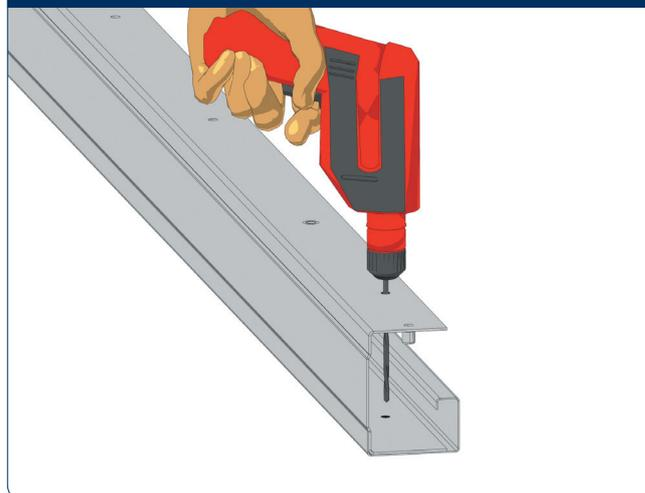
Просверлите сквозные отверстия в направляющих при помощи сверла под саморезы или анкерные болты.
