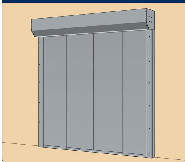
Проверьте правильность и надежность установки конструкции. Поднимите и опустите несколько раз полотно противодымной шторы. Убедитесь в отсутствии посторонних звуков и в надежности крепления всех элементов.
